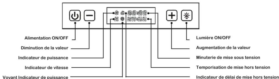
**Alimentation :** Permet d'allumer/éteindre la hotte et d'activer la minuterie de mise hors tension.
